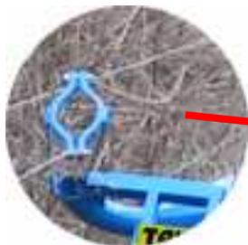
LE BLOCAGE DU FIL DANS L'ANNEAU PERMET D'EFFECTUER LA TENSION AVEC LE GAVAGE DU GODET
