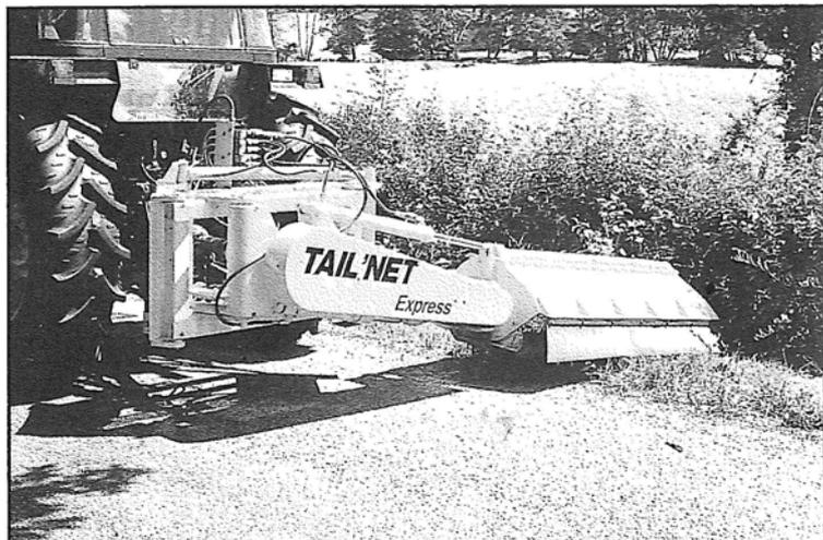
**Circuit vérin** : livré de série avec un distributeur à commande par câble, il nécessite ainsi une prise d'huile et un retour.
